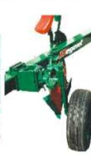
Roue pendulaire avec pneus en caoutchouc sur console centrale
