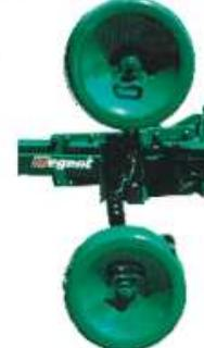
Double roue d'appui. Réglage en hauteur par boulon. Facilement réglable grâce à des poignées montées spécialement.
