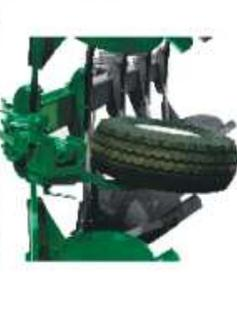
Pour un labour en bordure, la roue peut être basculée entre les deux derniers corps.
