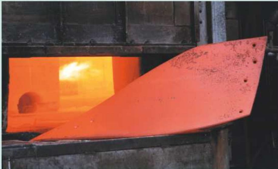
Les charrues **Regent** sont fabriquées à partir d'aciers à grain fin nordiques trempés, usinées dans des installations de fabrication ultramodernes à commande CNC et soudées en utilisant les dernières techniques actuelles de la robotique.
