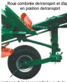
Avantages de la roue combinée ou de la roue d'appui pendulaire sur console centrale. Le centre de gravité de la charrue se trouve de façon plus favorable par rapport au tracteur. Dans les charrues avec 4 ou 5 corps, le labour en bordure est possible sans réglage.
